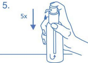
La solución así dispensada debe desecharse. La siguiente vez que el cabezal del dosificador se pulsa hacia abajo completamente (equivalente a una pulsación), ya dispensa la dosis correcta (fig. 6).
