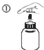
Insertar el adaptador en el cuello del frasco (figura 2). Asegurarse de que está bien fijo.
