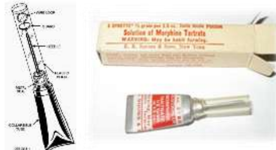
Figura 3. Diseño primer autoinyector (con permiso de MRC)
